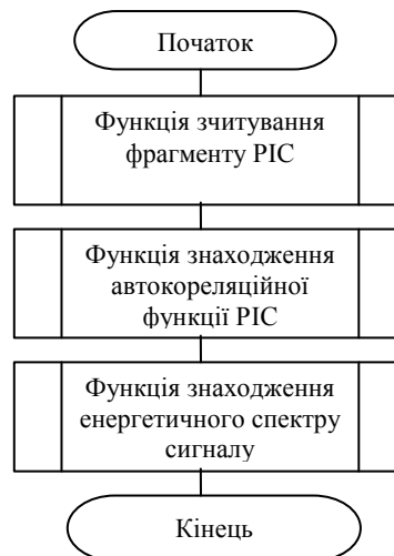
Рисунок 2 - Алгоритм функціонування програмного модуля опрацювання РІС
