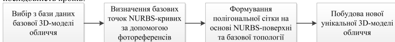
Рисунок 2 - Схема процесу автоматизованого 3D-моделювання обличчя людини
