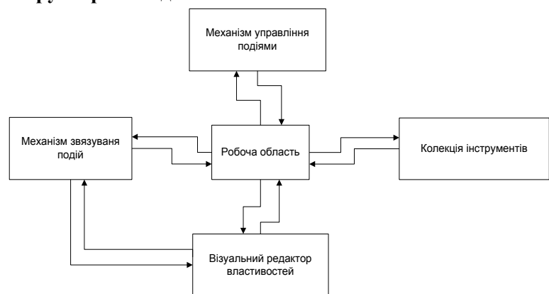
Рис 1. Функціональна модель прототипу конструктора
