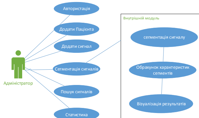
Рисунок 1- UML діаграма варіантів використання
