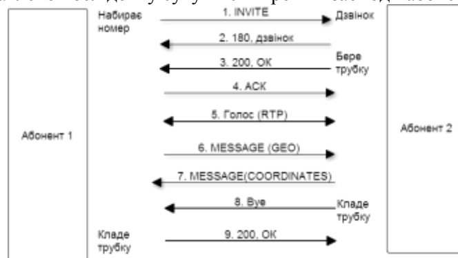
Рисунок 1 – Взаємодія абонентів по протоколу SIP
